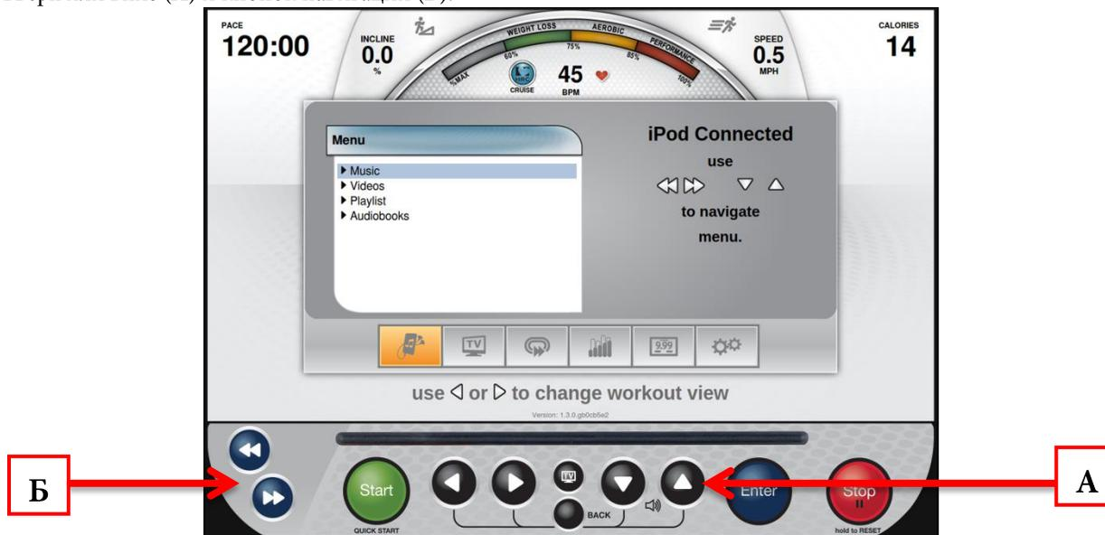
Во время воспроизведения можно управлять громкостью с помощью кнопок выбора вверх или вниз (В) и менять или повторять композиции с помощью кнопок навигации (Г).
