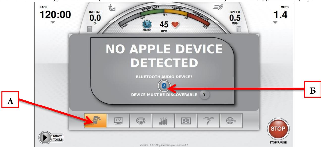
Консоль выполнит сканирование на наличие доступных устройств Bluetooth. По завершении сканирования просто коснитесь имени необходимого устройства (С), чтобы начать процесс сопряжения.
